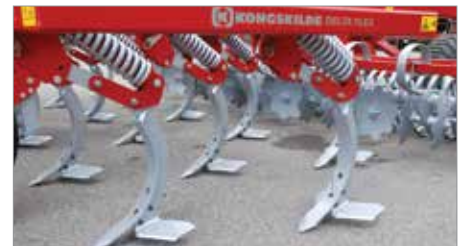
Speziell geformte Delta Flex Zinken.
