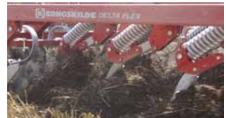
Optimale Einarbeitung und Vermischung von Boden und organischem Material.
