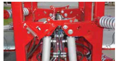
Automatisch hydraulische Transportverriegelung.
