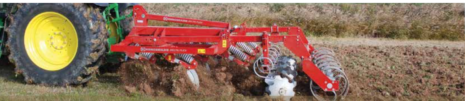
Große Aushubhöhe der Überlastsicherung von 25 cm.
