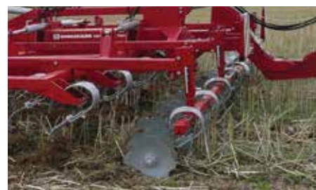
Vordere Schneidscheibenreihe am Vibro Flex 7400.
