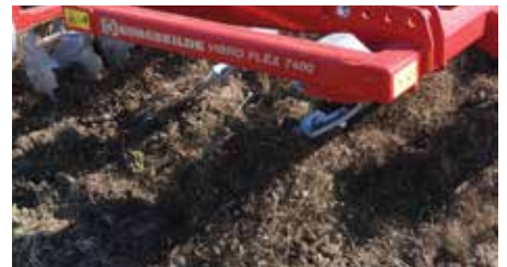
4 Zinkenreihen für eine intensive Einarbeitung und Vermischung von Ernterückständen.
